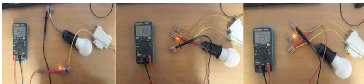
Рисунок 4. Схема соединения светодиодной лампы и подсветки: а — измерение тока в ветви; б — измерение напряжения на блоке индикации выключателя (лампа индикации и резистор); с — измерение напряжения на входе цепи
