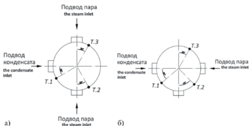
Рисунок 2. Расположение точек измерений температуры (Т.1, Т.2, Т.3) в водяной камере относительно трубопроводов подвода пара и конденсата: а) ПНД-1, б) ПНД-2, вид сверху Figure 2. Location of temperature measurement points (Т.1, Т.2, Т.3) in the water chamber relative to the steam and condensate supply pipelines: а) LPH-1 (low-pressure heater), б) LPH-2, top view
