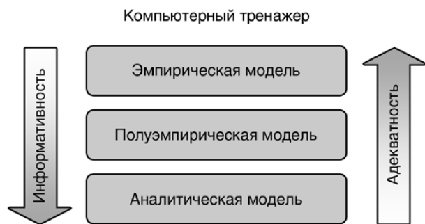
Рисунок 2. Влияние информативности и адекватности тренажера в зависимости от используемой математической модели
