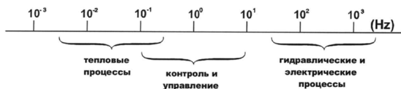
Рисунок 1. Частотные диапазоны динамических характеристик процессов в энергообъектах
