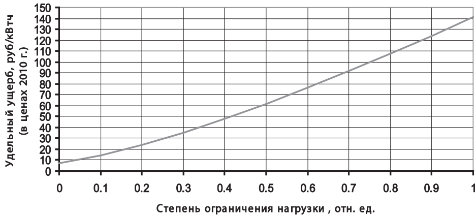
Рис. 5. Обобщенная характеристика удельного ущерба от аварийных ограничений нагрузок потребителей устройствами АЧР при возникновении дефицитов генерирующей мощности в ЕЭС России (в ценах 2010 г.), руб/кВтч.
