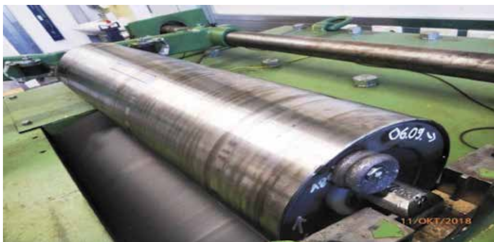
Рисунок 7. Испытательный несущий ролик №0609 с клейкой лентой (стрелка) и груз (круг) на испытательном стенде несущего ролика Figure 7. Test carrier roller №0609 with adhesive tape (arrow) and weights (circle) on the carrier roller test stand
