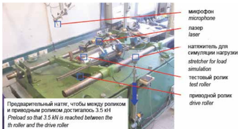
Рисунок 5. Установка для испытания несущих роликов (испытательный стенд) Figure 5. Installation for testing carrier rollers (test bench)
