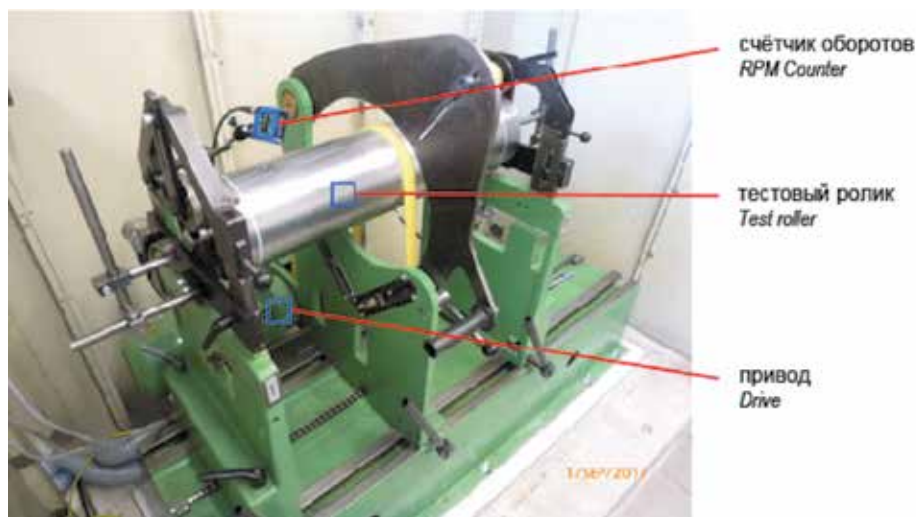
Рисунок 4. Установка для проверки дисбаланса на несущих роликах Figure 4. Installation for checking imbalance on carrier rollers
