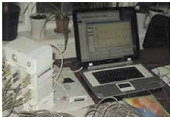
Рисунок 1. ПИ-1: число каналов — 6; исполнение — общетехническое; тип объектов — предприятия энергетики
