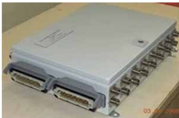
Рисунок 3. ПИ-3: число каналов — 32; исполнение — общетехническое; тип объектов — судовые газотурбинные установки, АЭС
