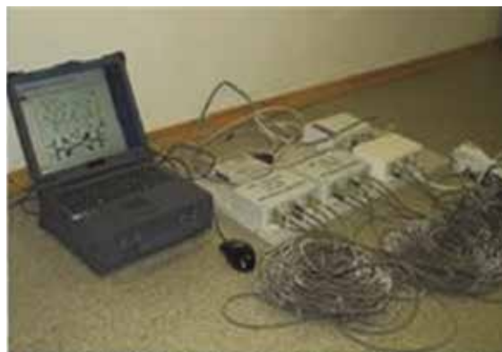
Рисунок 2. ПИ-2: число каналов — 16; исполнение — общетехническое; тип объектов — судовые газотурбинные установки и дизель-генераторы
