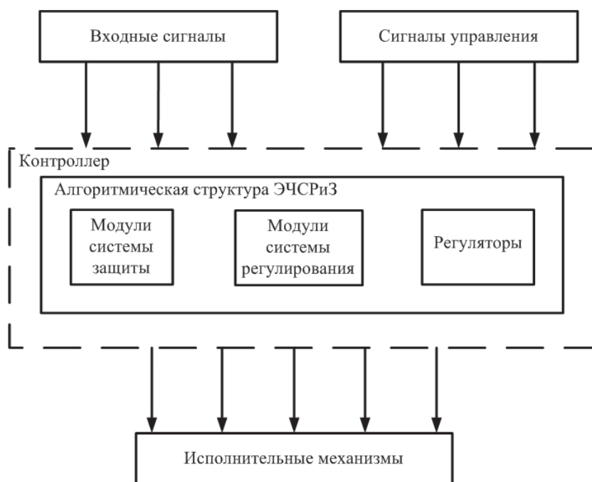
Рис. 2. Алгоритмическая структура ЭЧСРиЗ паровой турбины.
